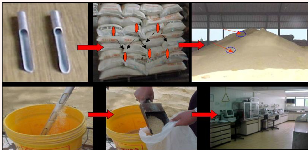
Figura 1. Muestreo de materias primas y envío al laboratorio.
